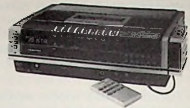
Bild 8. Zwei zusätzliche Videoköpfe befähigen diesen VHS-Recorder V-8700 von Toshiba zu einem Standbild ohne Störzone
