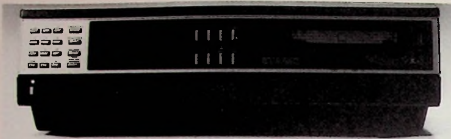
Bild 7. Als erstes Heimvideogerät ist der Grundig-Video recorder Video 2 x 4 Super mit einem Bandzählwerk ausgestattet, das nach Einschieben der Cassette deren Spieldauer sowie die zeitliche Bandposition feststellt und auf dem Display anzeigt. Foto: Grundig
