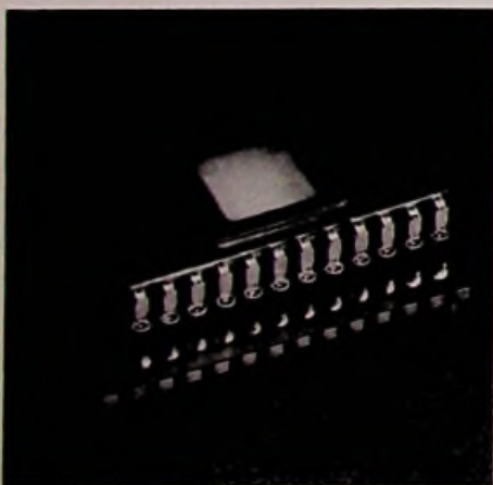
Bild 5. ROM-lose Version des SDA 2110 mit aufgestecktem Programmspeicher
