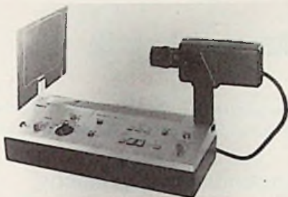
Bild 18. Kann Texte einblenden: Video-Mixer von Panasonic
